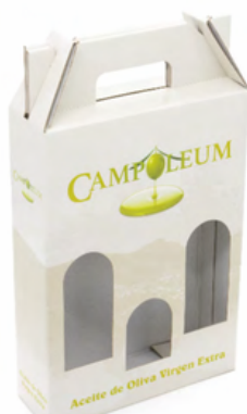
Estuche Asa Bolsa con Ventanas. Impresión CMYK + Laminado Brillo + Papel 275 gr. + Plancha E (EX 120 gr. + TR 75 gr. + DR 120 gr.). Medidas: 20,8 x 7 x 36,6 cm.
