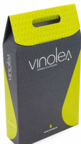
Estuche Asa Bolsa. Impresión CMYK + Laminado Mate + Papel 275 gr. + Plancha E (EX 120 gr. + TR 75 gr. + DR 120 gr.). Medidas: 23,2 x 8 x 40,2 cm.
